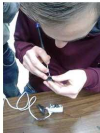
Εικόνα 3: Ειδική μετατροπή της κάμερας ώστε να συλλαμβάνει μόνο το υπέρυθρο φως
