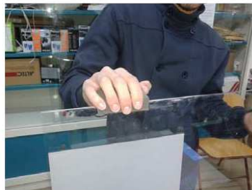
Εικόνα 10: Μέλος της ομάδας λειανεί με γυαλόχαρτο το περίγραμμα της επιφάνειας ώστε να επιτευχθεί το φαινόμενο της Ολικής Εσωτερικής Ανάκλασης
